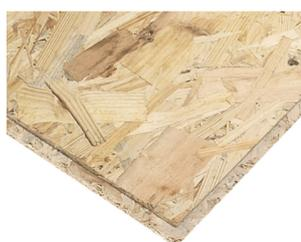
Les dalles OSB sont composées de lamelles minces et longues, collées entre elles par une résine synthétique et pressées en couches. Les dalles OSB sont rainurées bouvetées. Utilisées en plancher, elles sont environ 40% plus résistantes que les dalles de particules classiques.
