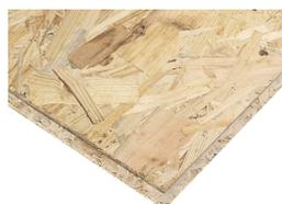
**Dalles OSB :** Les dalles OSB sont composées de lamelles minces et longues, collées entre elles par une résine synthétique et pressées en couches. Les dalles OSB sont rainurées bouvetées. Utilisées en plancher, elles sont environ 40% plus résistantes que les dalles de particules classiques.
