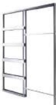
Pour cloisons à ossature métallique et plaques de plâtre, épaisseurs cloisons finie 95 et 98mm, rail en aluminium anodisé et chariots à roulements haute qualité étanches, habillage avec couvre joint intégré, réglage de l'ouverture de la porte breveté, guide bas de porte auto-centré.
