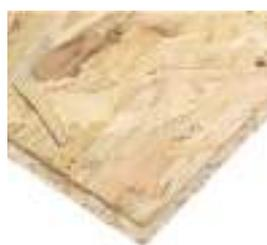
Les dalles OSB sont composées de lamelles minces et longues, collées entre elles par une résine synthétique et pressées en couches. Les dalles OSB sont rainurées bouvetées. Utilisées en plancher, elles sont environ 40% plus résistantes que les dalles de particules classiques.
